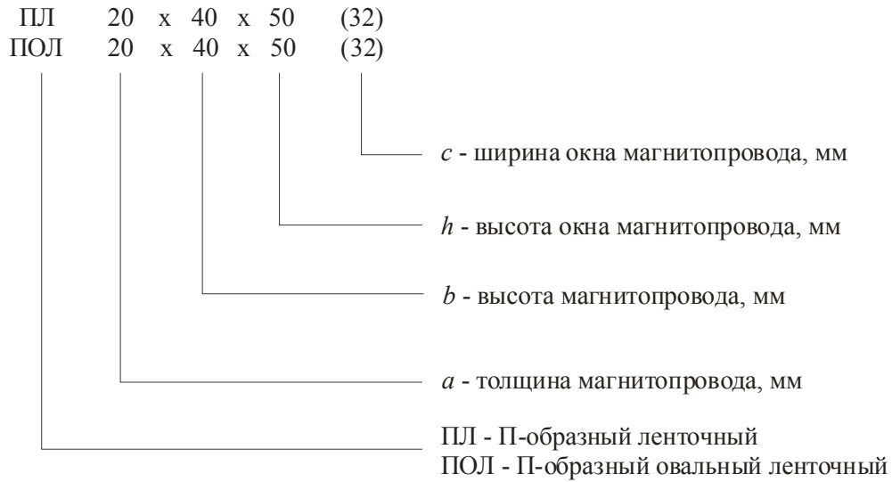
Рисунок 7 – Структура условного обозначения типоразмера магнитопроводов ПЛ и ПОЛ.
