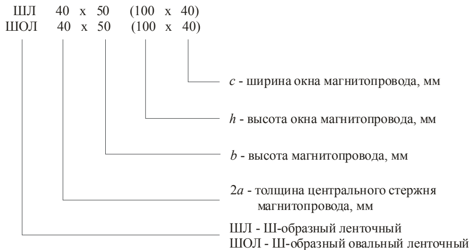
Рисунок 8 – Структура условного обозначения типоразмера магнитопроводов ШЛ и ШОЛ.
